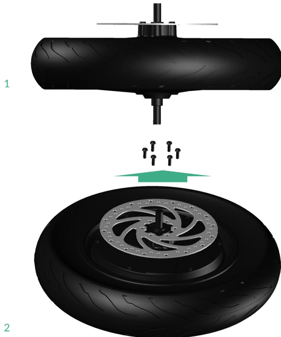
1. Lege das Vorderrad flach auf eine Arbeitsfläche, so kannst du die Schrauben der Bremsscheibe am besten lösen (siehe Bild 1).
