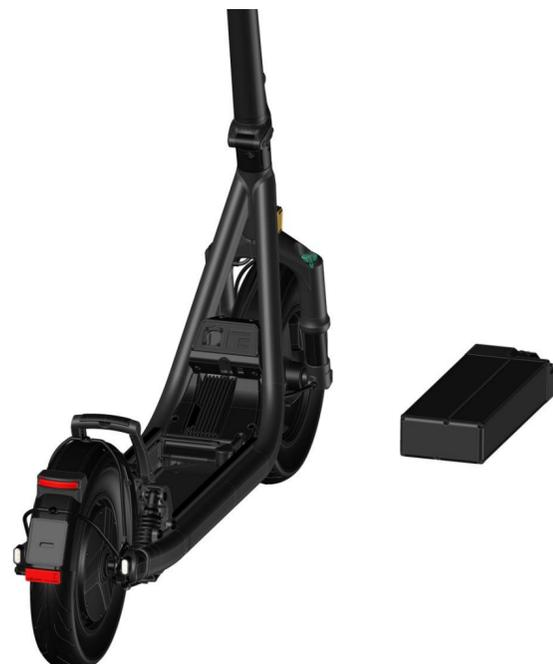
1. Damit du das Hinterrad vollständig ausbauen kannst, musst du das Motorkabel vom Steuergerät (Controller) trennen.
