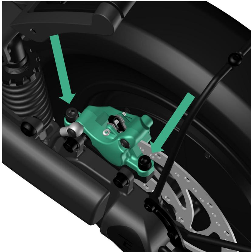
1. Während du immer noch den Bremshebel fest gezogen hältst, ziehst du nun die beiden Bremssattelschrauben (H 5) mit ca. 7 Nm fest (siehe Bild 1).
